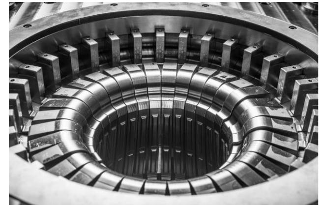
Transferpressen und Pressen für Folgeverbund mit maximalen Presskräften bis zu 6.300 kN stehen für unsere Serienfertigung zu Verfügung. Das Material kann vom Coil oder von der Platine verarbeitet werden.
