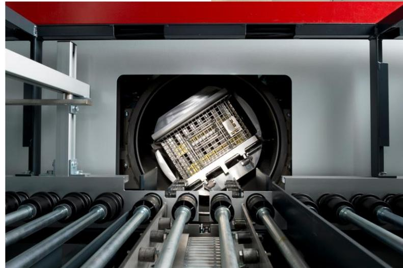
In unserem klimatisierten Messbereich finden alle taktilen und berührungslosen Messverfahren Anwendung. Bauteiltests im Schleuder-/ Drehzahlprüfstand können bis zu 25.000 rpm durchgeführt werden.
